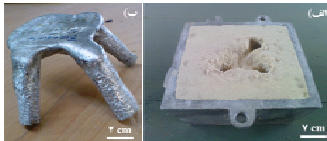
شکل ۳- (الف) نمونه‌ای از قالب ماسه‌ای مورد استفاده در این تحقیق به همراه (ب) یک نمونه از قطعه ریختگی آلیاژ منیزیم.
