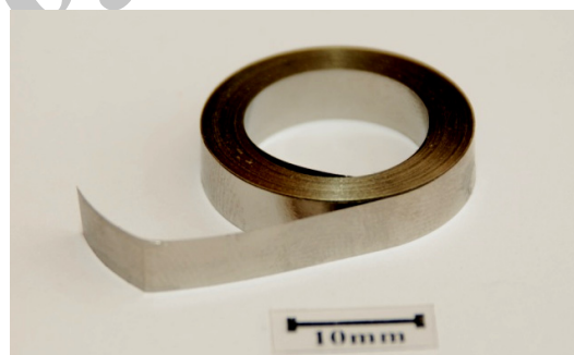
شکل ۳- نمونه‌ای از فویل ۵ میلیمتری تولید شده به روش ریخته ریزی که به شکل حلقوی پیچیده شده است.
