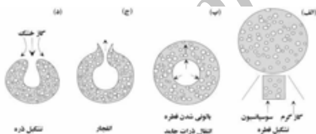
شکل ۴- مراحل تشکیل پودر آگلومره سرامیکی در فرایند خشک کردن پاششی [۱۲].
