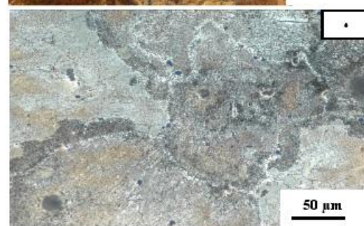
شکل ۲- ریزساختار الف) آلیاژ ریختگی. ب) ناحیه روکش کاری شده، ج) ناحیه روکش کاری شده پس از عملیات حرارتی و از FSP، د) فلز پایه پس از عملیات حرارتی و ه) ناحیه روکش کاری شده پس از عملیات حرارتی
