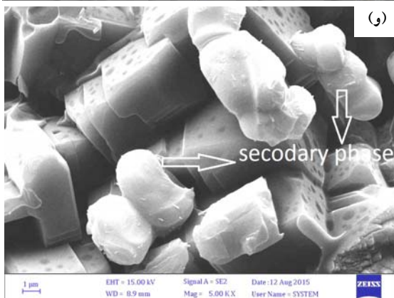
شکل ۴- تصاویر میکروسکوپی الکترونی روبشی از سطح مقطع شکسته شده شیشه و نمونه‌های کریستاله شده در دمای 850^{\circ} درجه سانتی‌گراد برای مدت ۸ ساعت: الف) \text{Cr}_{0.25} شیشه، ب) \text{Cr}_0 ، ج) \text{Cr}_{0.1} ، د) \text{Cr}_{0.25} ، ه) \text{Cr}_{0.4} ، و) \text{Cr}_{0.5}
