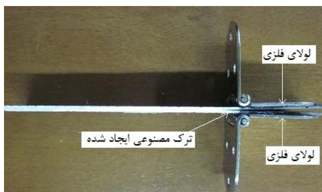
شکل ۲- نمایی از نمونه آماده شده برای آزمایش برش بین لایه‌ای نوع I
