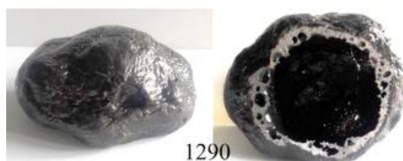
شکل ۱۰- تصویری از ظاهر و سطح زیرین نمونه SG50-5SiC در ۱۲۹۰ درجه سانتی‌گراد
