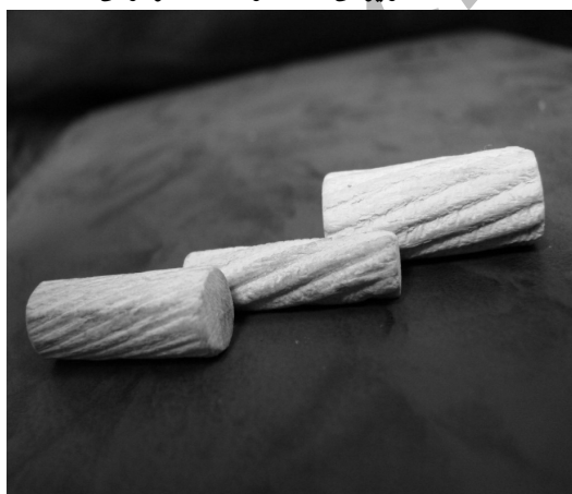
شکل ۲- دوپل‌های گونه چوبی ممرز با قطرهای ۱۰، ۸ و ۶ میلی‌متر (از راست به چپ)
