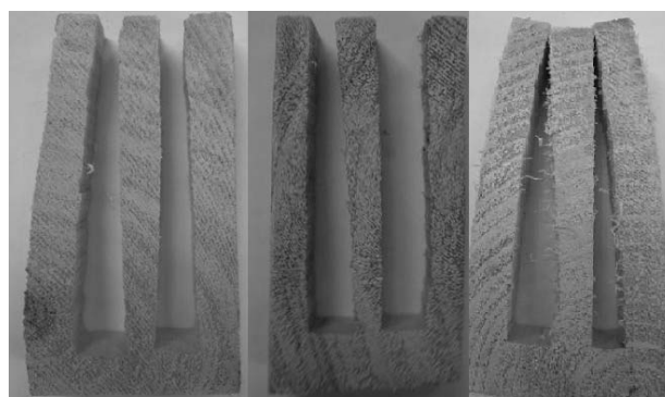
شکل ۴- برون سختی در نمونه‌های چنگالی شکل (الف: برنامه T_{10}E_4 ، ب: برنامه T_8E_3 ، ج: برنامه T_6E_3 )
