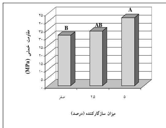
شکل ۱- اثر میزان سازگارکننده بر ویژگی‌های خمشی چندسازه
