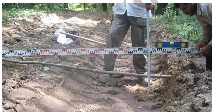
شکل ۲- اندازه‌گیری عمق رد چرخ در مسیرهای چوب‌کشی
