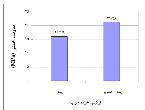
شکل ۲- اثر ترکیب چوبی بر مقاومت خمشی (راست) و مدول الاستیسیته (چپ)
