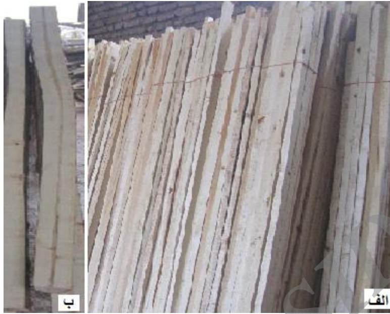
شکل ۷. الوار استحصالی از الف) گرده‌های کم‌قطر صنوبر برای مصارف نجاری و تخته‌قالب‌بندی، و ب) گرده‌های کم‌قطر صنوبر دارای خمیدگی و تغییرات رنگی اطراف مغز.
