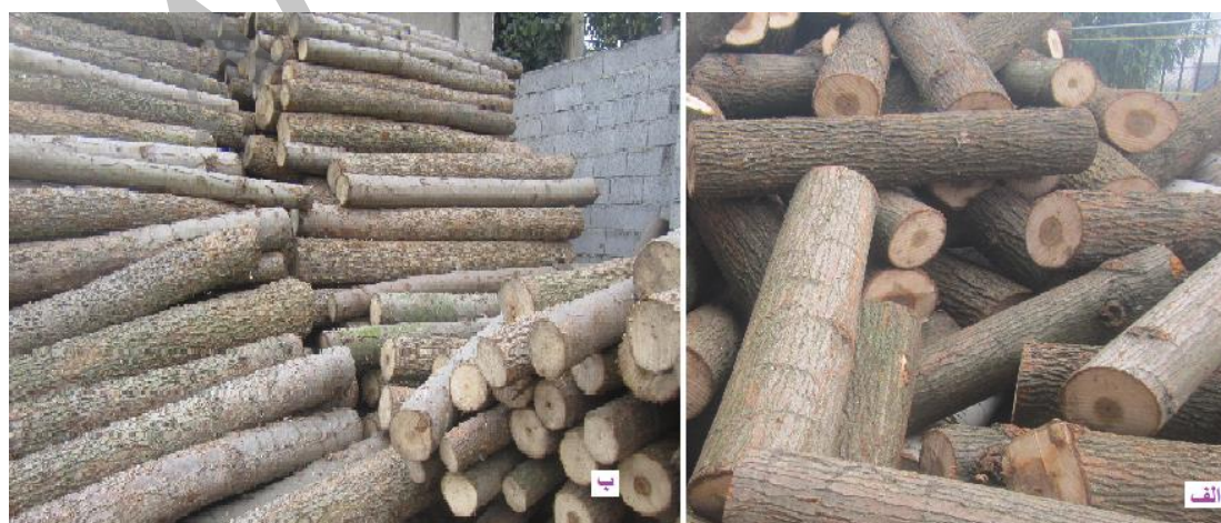
شکل ۶. الف) گرده‌های کم‌قطر صنوبر عاری از معایب و با قطر مناسب درجه یک، ب) گرده‌های کم‌قطر صنوبر عاری از معایب که به سبب محدودیت قطری درجه دو هستند.
