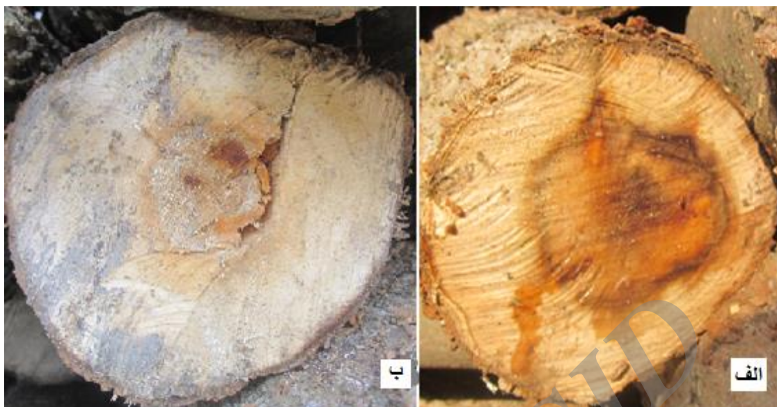
شکل ۴. عیب نامنظمی سطح مقطع یا پارابلوئیدی همراه با الف) تغییرات رنگی، و ب) گردگسیختگی.
