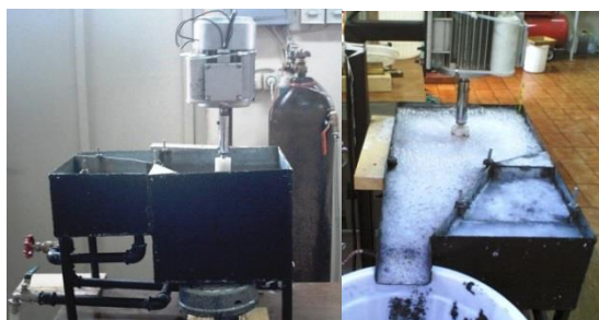
شکل ۱. سلول شناورسازی آزمایشگاهی مورد استفاده برای جداکردن ذرات مرکب
