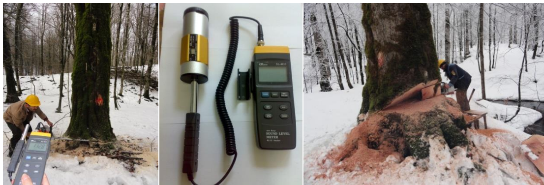
شکل ۱. اندازه‌گیری شدت صدا با دستگاه صداسنج در مرحله بن‌زنی و بن‌بری و نحوه کالیبراسیون صداسنج
