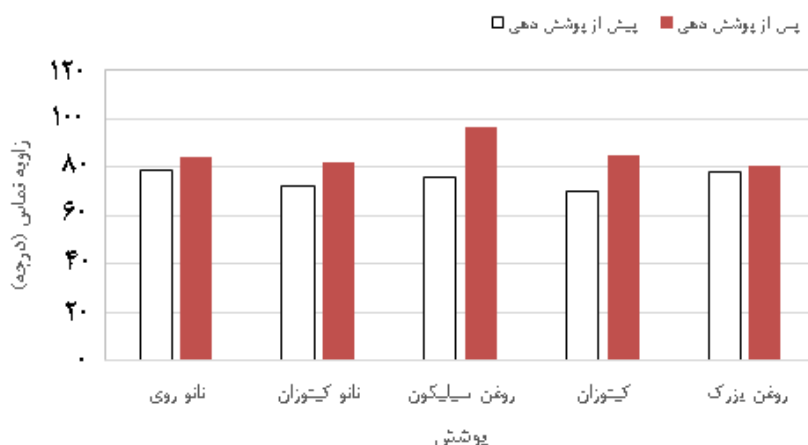
شکل ۸. زاویه تماس قطره آب در سطح چوب راش پیش و پس از پوشش‌دهی با پوشش‌های گوناگون
