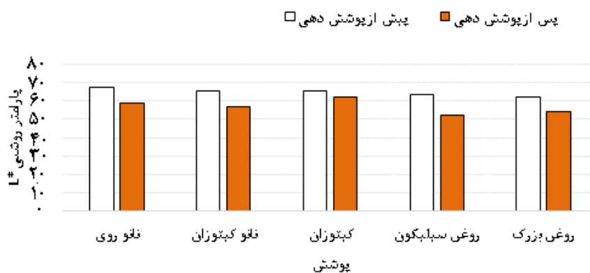
شکل ۲. تغییر پارامتر روشنایی L* در چوب راش پیش و پس از پوشش‌دهی با پوشش‌دهنده‌های گوناگون
