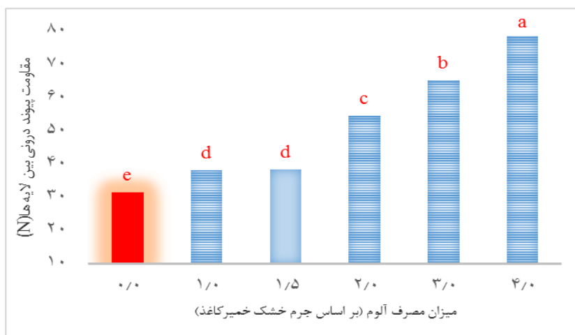
شکل ۸. مقاومت پیوند درونی بین لایه‌های مقوا در سطح کاربرد ۱ درصد روزین
