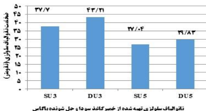
شکل ۱. مقایسهٔ ضخامت سلولز نانوفیبریله شدهٔ تهیه شده از خمیر کاغذ سودا و خمیر حل شونده باگاس در کیفیت‌های مختلف
