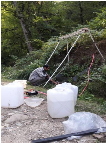
شکل ۱. استقرار شبیه‌ساز بارش بر روی دامنه بالادست جاده جنگلی
