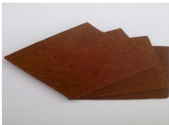
شکل ۱. کامپوزیت چوب-پلاستیک ساخته‌شده از آرد ساقهٔ توتون - پلی‌لاکتیک‌اسید
