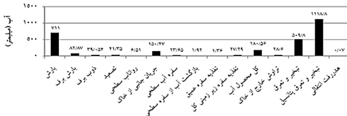
شکل ۷. اجزای بیلان آب شبیه‌سازی شده به وسیله مدل SWAT (مقادیر بر حسب میلی‌متر)
