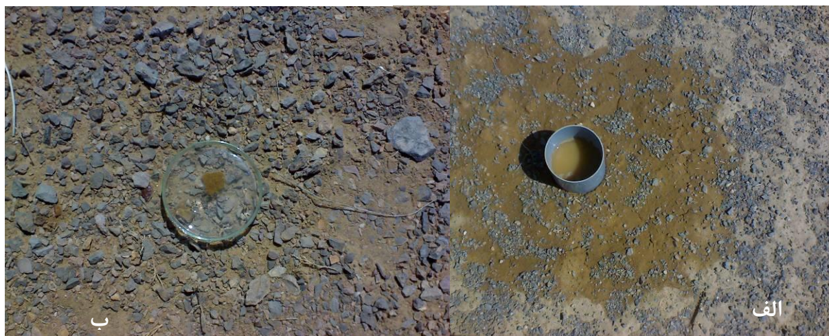
شکل ۱۳. الف) اندازه‌گیری نفوذپذیری با استفاده از لوله‌ای با قطر داخلی و ارتفاع ۱۰ سانتی‌متر در واحد ۱۳۴؛ ب) امتیازدهی به شاخص متلاشی‌شدن در واحد ۱۱
