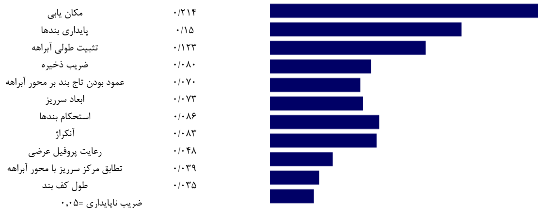
شکل ۲. نمودار وزن دهی معیارها، بر اساس AHP و با استفاده از نرم‌افزار Expert choice
