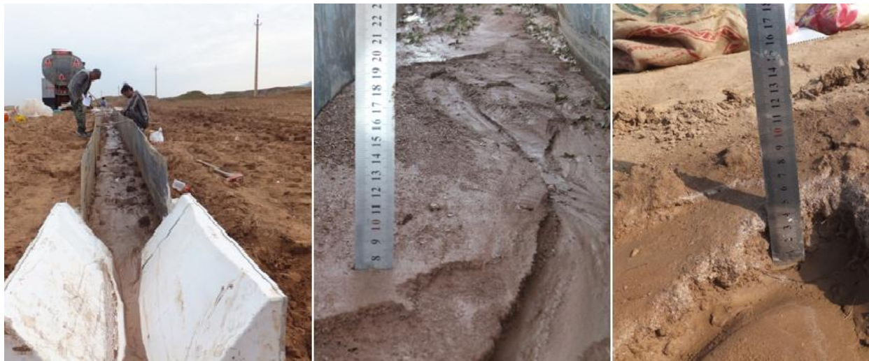
شکل ۳. اندازه‌گیری عمق کنش و رسوبات حاصل از جریان رواناب در پلات‌های صحرايي
