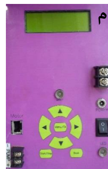
شکل ۱. الف: شبیه ساز باران طراحی شده؛ ب: صفحه بارش؛ ج: فشارسنج؛ د: موتور پمپ التریکی؛ ه: برد کنترلی
