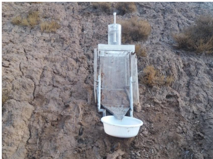
شکل ۵. دستگاه شبیه‌ساز باران (kampHorst) برای اندازه‌گیری میزان رسوب، رواناب و نفوذ پذیری در هر یک از واحدهای کاری
