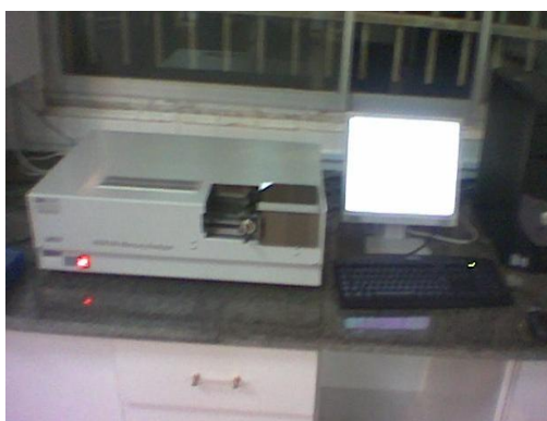
شکل ۲- دستگاه Mercury Analyzer مدل 254 MA
