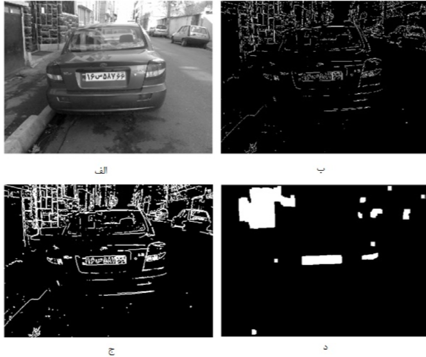
شکل ۳-۳: تصویر خودرو در مراحل مختلف پردازش تصویر. الف) تصویر در مقیاس خاکستری. ب) لبه‌یابی با عمل‌گر روبرتس. ج) تقویت لبه‌ها. د) پرکردن نواحی بسته
