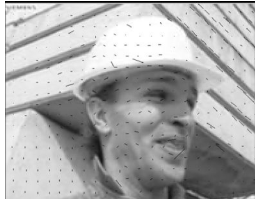
(شکل - ۹): نشان دادن بردارهای حرکت محاسبه شده برای بلوک های ۸×۸ برای تصویر Foreman
