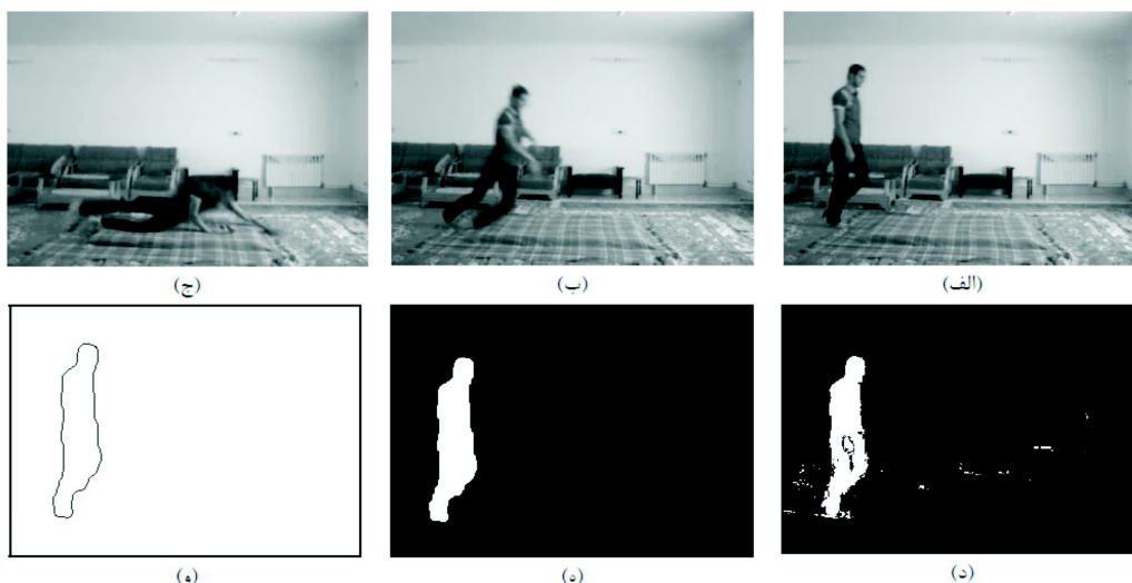
(شکل - ۱۳): نتایج شبیه‌سازی با وجود یک فرد؛ (الف) تصویر فرد هنگام راه رفتن (ب) تصویر فرد در آستانه افتادن (ج) تصویر فرد در لحظه افتادن (د) استخراج تصویر پیش‌زمینه (ه) فیلترینگ (و) استخراج کانتور پیش‌زمینه.
