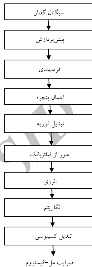
(شکل-۱) : مراحل محاسبه MFCC
