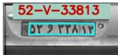
(شکل-۱۰): خروجی الگوریتم پلاک‌خوان برای تصویر بازسازی شده به روش پیشنهادی و با استفاده از روش انطباق تصویری وندول (Figure-10): Results of LPR algorithm for the reconstructed image using the proposed SR plus Vandewalle image matching method
