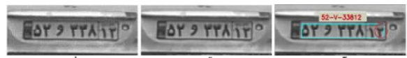
(شکل-۱۹): خطای رخ داده برای تصاویر واقعی در الگوریتم پلاک‌خوان (۱): تصویر ورودی، ۲: تصویر بازسازی شده با روش ابرتفکیک‌پذیری پیشنهادی همراه با روش انطباق تصویری کرن، ۳: خروجی الگوریتم پلاک‌خوان به‌همراه مشخص کردن محل خطای رخ داده
