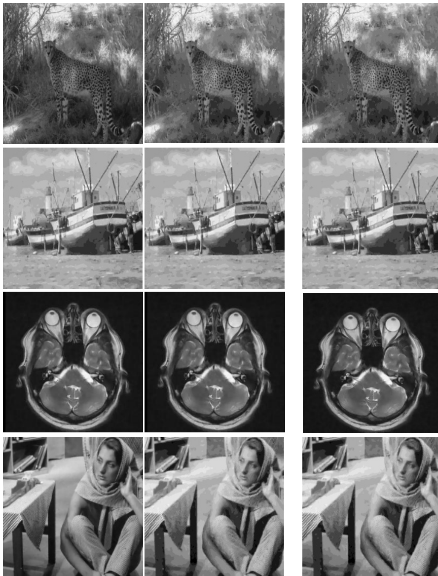
(شکل-۲): نتایج حذف نویز تصویر با نویز گوسین و \sigma = 20 برای یکصد تکه. ستون سمت راست: با استفاده از روش یادگیری واژه‌نامه مبتنی بر تطبیق فضا [27]. ستون وسط: با استفاده از روش یادگیری واژه‌نامه مبتنی بر K-SVD. سمت چپ: با استفاده از روش یادگیری واژه‌نامه مبتنی بر روش پیشنهادی.
