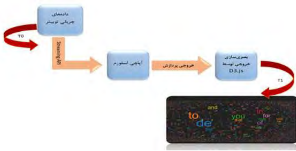
(شکل-۲): معماری طرح‌واره داشبورد (Figure-2): Schematic architecture of the dashboard
