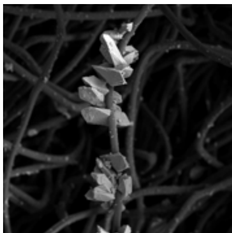
شکل ۱۱ - رسوب کلسیم شکل گرفته روی فیلتر در محل شکاف
