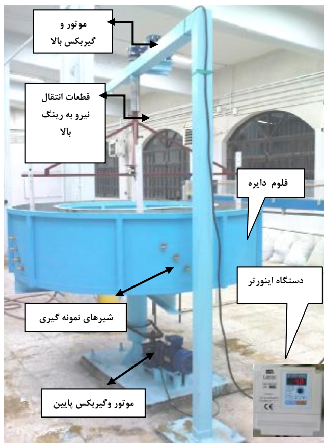
شکل ۳- نمای کلی از سیستم فلوم دایره‌ای دانشگاه شهرکرد
