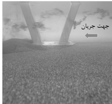
شکل ۱- نمایی از فلوم آزمایشگاهی و گروه پایه پل کج نصب شده در ترازهای مختلف
