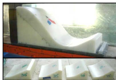
شکل ۲- مدل آزمایشگاهی سرریز اوجی و پرتاب کننده‌های جامی متحرک با زوایای مختلف 30^\circ ، 35^\circ ، 40^\circ و 45^\circ
