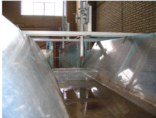
شکل ۴- آبپایه لبه پهن برای کنترل جهش هیدرولیکی در مقاطع دوزنقه‌ای
