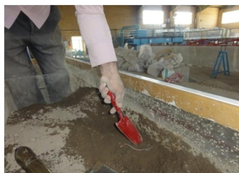
شکل ۲- نقاط اندازه‌گیری رطوبت و نیترات در هر محفظه و نمایی از نمونه‌برداری خاک در نقاط مشخص شده پس از انجام آزمایش
