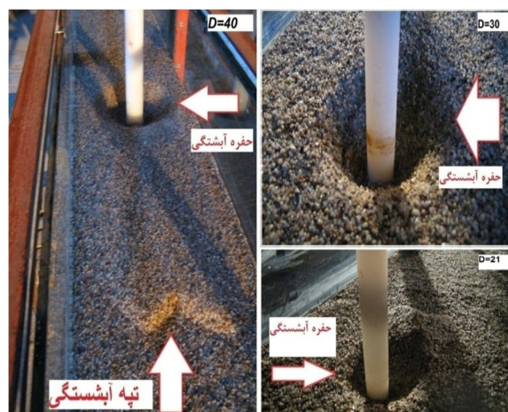
شکل ۶- نمایی از آبشستگی در حالت بدون طوق
