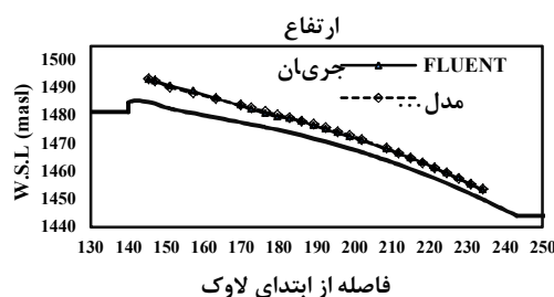
شکل ۱- ارتفاع، سرعت و گرادیان هیدرولیکی بر روی تندآب سرریز گزینه ۱
