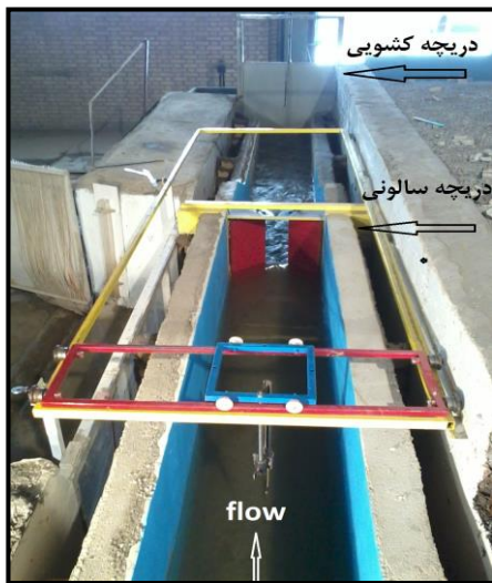
شکل ۳- نمای دریچه سالونی و کشویی در کانال
