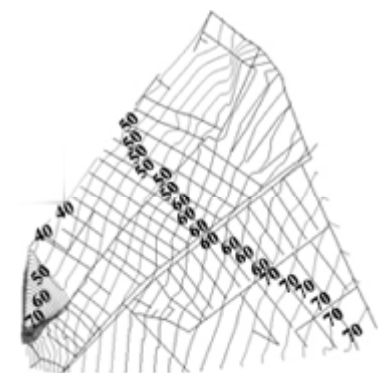
شکل ۱۰- خطوط هم فشار در شبکه توزیع آب شهرک بزین در ساعت ۴ روز اول ماه دی سال ۱۳۹۱
