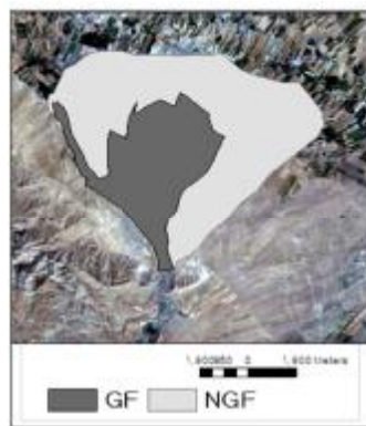
شکل ۱۱- نقشه خطر سیل حاصل از اطلاعات ژئومورفولوژیکی (GF)
