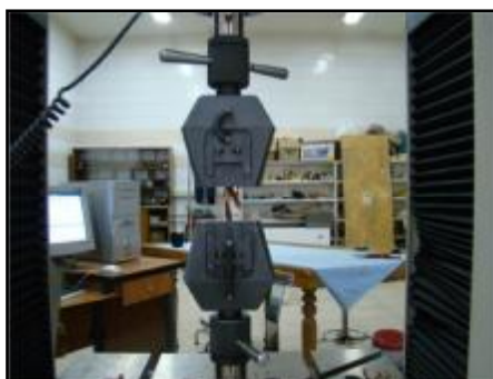
شکل ۶- تعیین نیروی کششی ریشه با استفاده از دستگاه اینسترون
