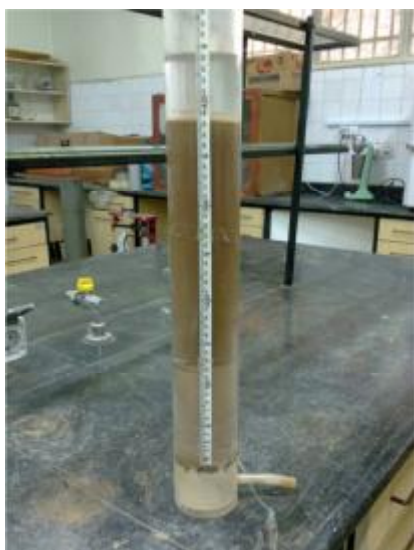
شکل ۱- تصویری از نفوذ آب به خاک تحت بار افتان در سیلندر آزمایشگاهی
