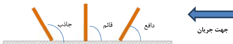
شکل ۱- نحوه قرارگیری آبشکن‌ها سه حالت دافع، عمودی و جاذب
