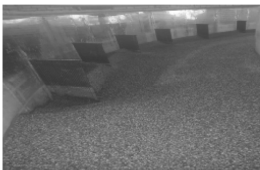
شکل ۴- چگونگی قرارگیری آبشکن‌ها در حالت دافع
