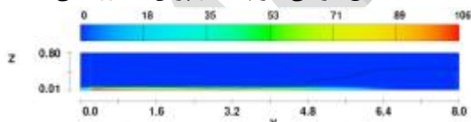
ج - مقطع طولی فلوم در طول پرش هیدرولیکی
