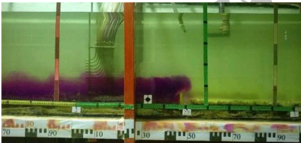
شکل ۱۰- نمایی از برخورد پیشانی جریان غلیظ با موانع
